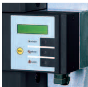
Sistema di controllo – Ultrapac 2000 Superplus . Chiare informazioni sul display dell'attuale stato operativo. Indicazione del momento migliore per la sostituzione della cartuccia dessiccante. Contatto libero da potenziale per segnalazione esterna.
